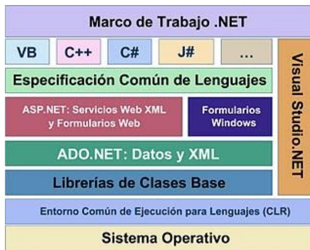
Figura A.6 Los componentes de la plataforma .Net.
