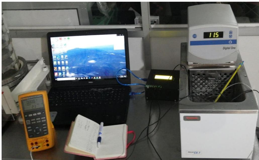
Figura 2.6 Calibración de termopares en baño térmico
