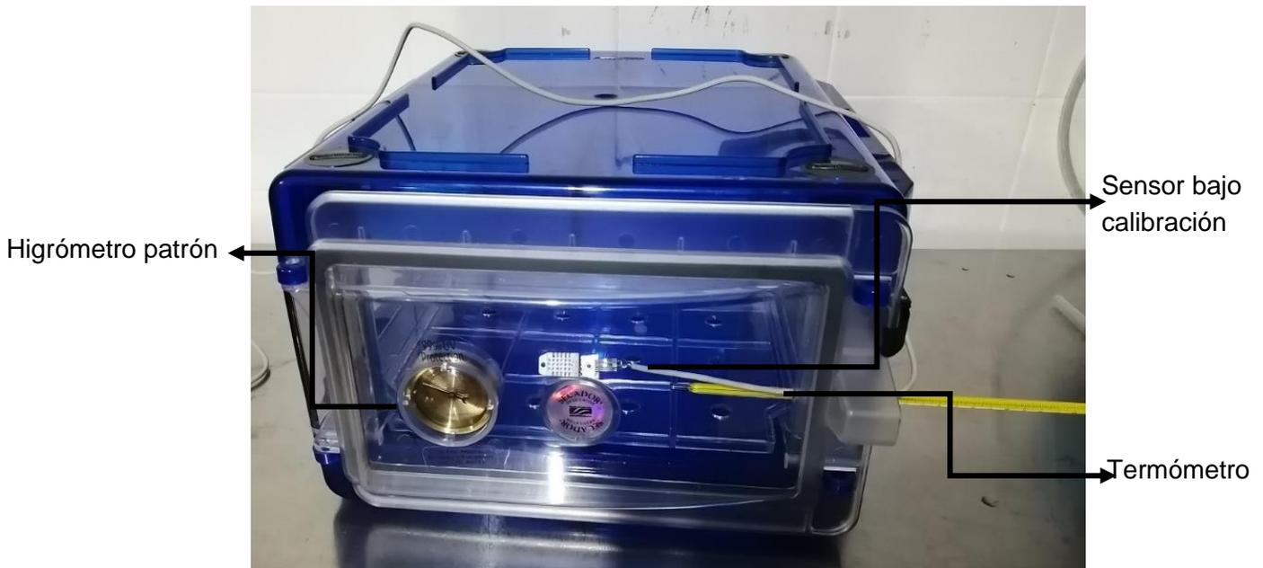
Figura 2.10 Calibración del sensor de humedad DHT 22 en cabina con higrómetro de caratula
