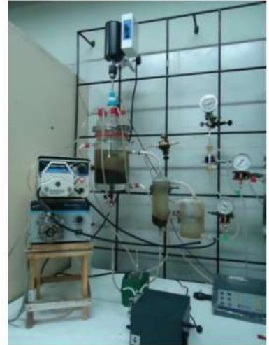
Figura 1.6 Esquema y vista del reactor de membrana
