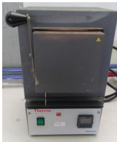
Figura 2.4 Mufla marca Thermo Scientific.
