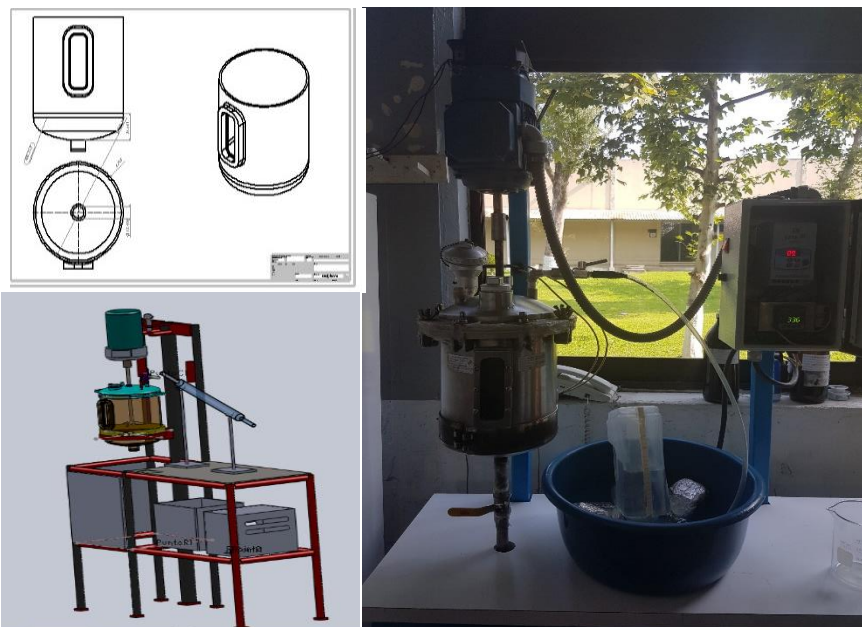
Figura 2.6 Reactor escala laboratorio con control de temperatura y agitación.
