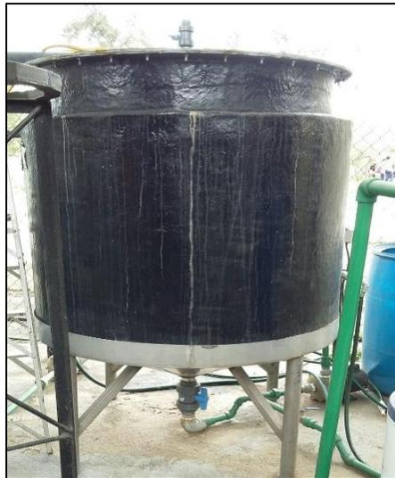
Figura 2.12 Reactor de biopelícula en modo hidrolítico
