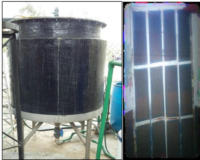
Figura 2.7. Reactor de biopelícula (exterior e interior)
