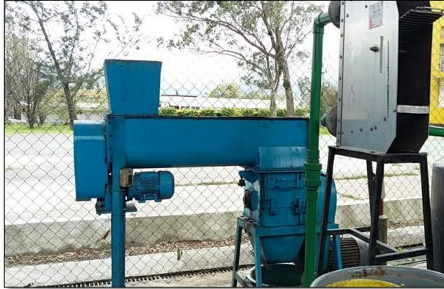
Figura 2.5 Molino triturador de cuchillas con tornillo transportador
