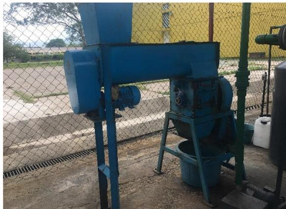
Figura 2.4 Molino triturador marca VEYCO modelo MCV 320.
