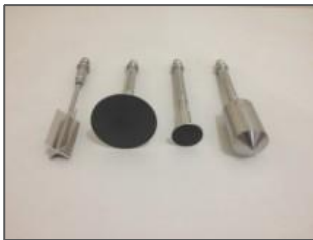
Figura 2.3 Geometrías para caracterización reológica (de izquierda a derecha: agitador ST22-4V-40-SN10120, cono CP50-2/TG-SN6659, cono CP25-2/TG-SN6614 y cilindro CC27/T200/AL-SN9337)
