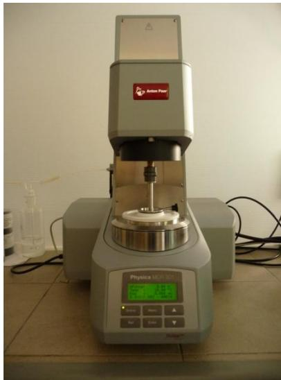
Figura 2.5 Reómetro Anton Paar MCR Modelo 301
