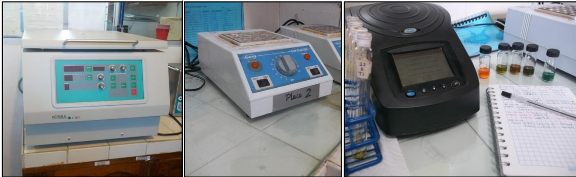
Figura 2.11. Centrífuga, placa digestora y espectrofotómetro utilizados
