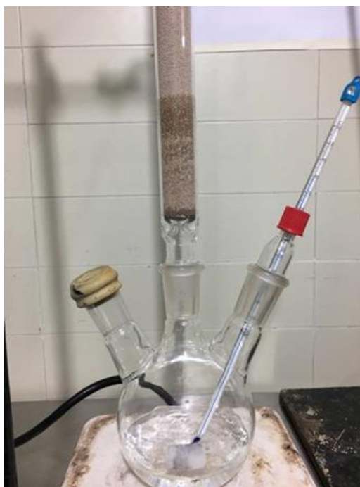
Figura 2.7 Deshidratación de etanol por adsorción TSA
