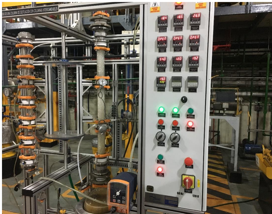
Figura 2.2 Destilación de mosto fermentativo de jugo de sorgo
