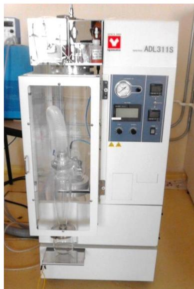
Figura 2. 8 Secador por aspersión Yamato ADL311S
