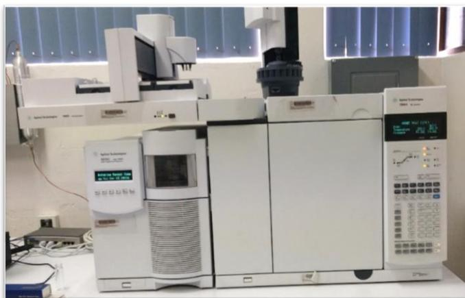
Figura 2. 7 Equipo de cromatografía
