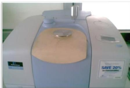
Figura 2. 5 Equipo FT-IR con detector ATR Perkin Elmer
