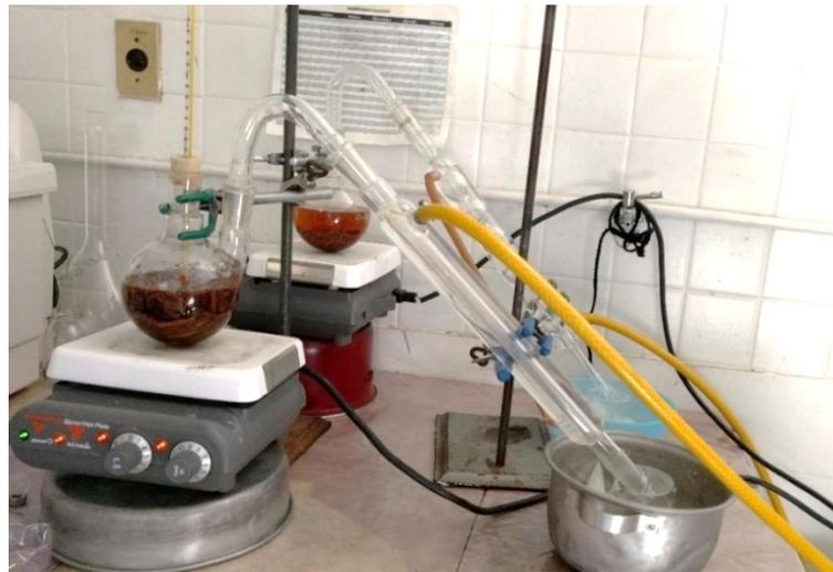
Figura 2. 3 Equipo de extracción del aceite esencial de canela
