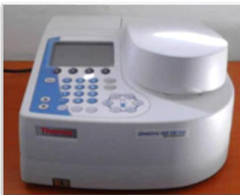
Figura 2. 6 Espectrofotómetro UV/VIS Genesys 10S
