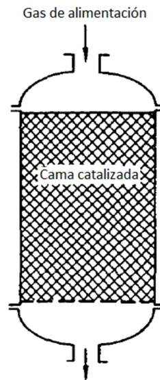
Figura 1.3. Esquema de un reactor de cama empacada con operación adiabática
