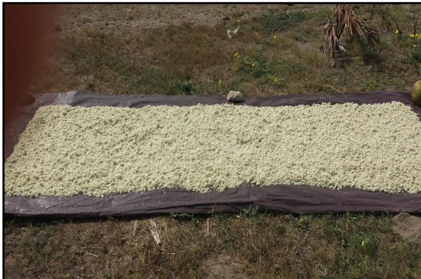
Figura 2.6 Celulosa expuesta a secado mediante radiación solar
