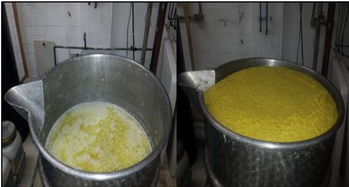
Figura 2.7 Incremento de volumen durante la reacción alcalina
