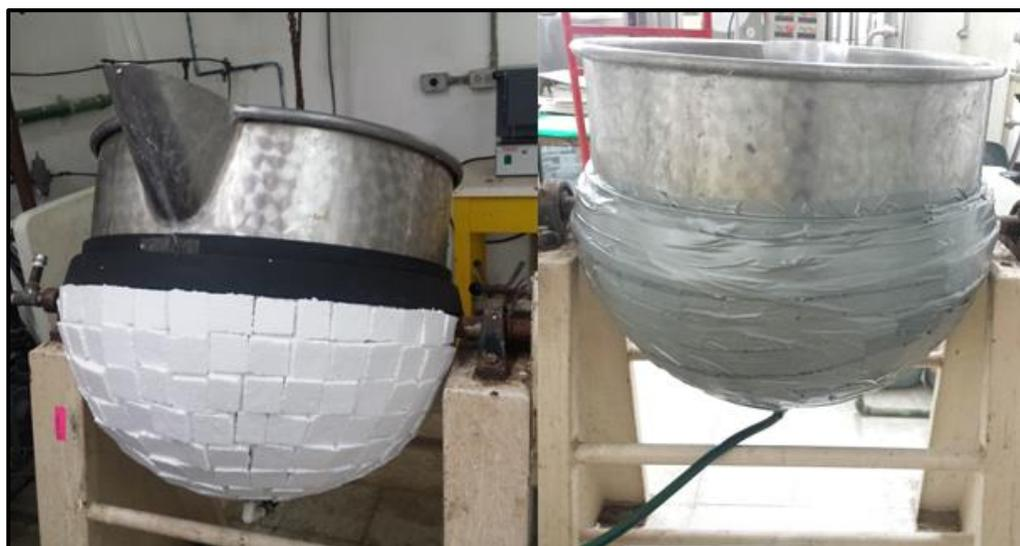
Figura 3.12 Aislamiento de la chaqueta de calentamiento del equipo destinado para la hidrólisis enzimática a nivel planta piloto
