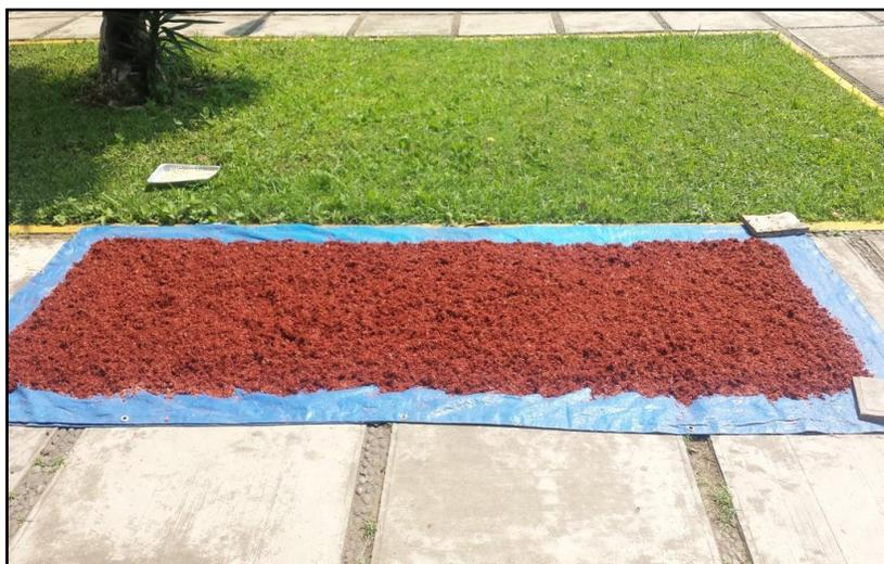
Figura 2.5 BSD pre hidrolizado con  $H_2SO_4$  expuesto a secado solar
