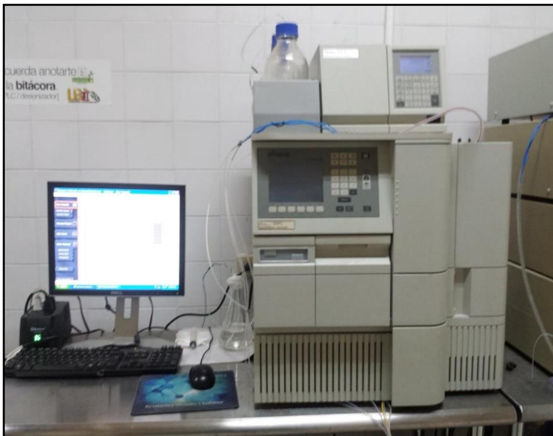
Figura 2.4 Equipo HPLC Waters para cuantificación de productos
