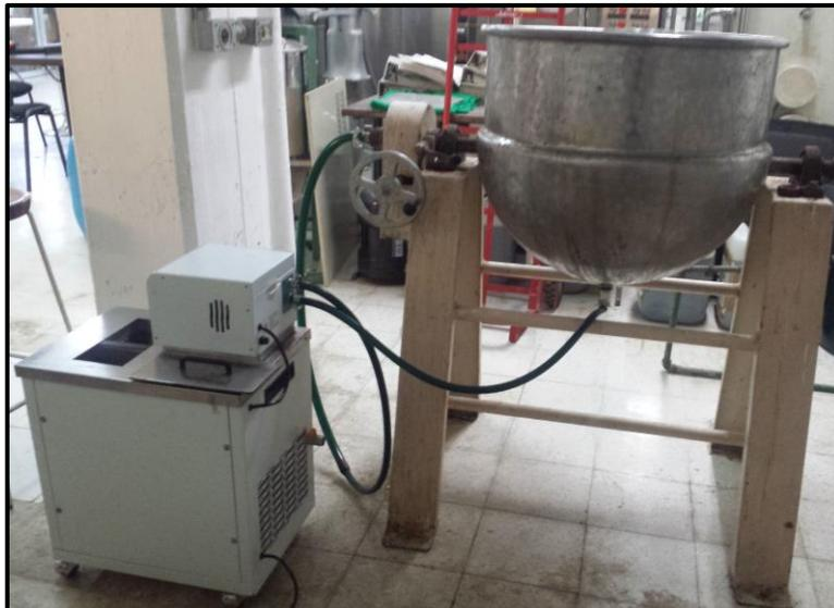
Figura 3.13 Tanque adaptado para la hidrólisis enzimática a nivel planta piloto
