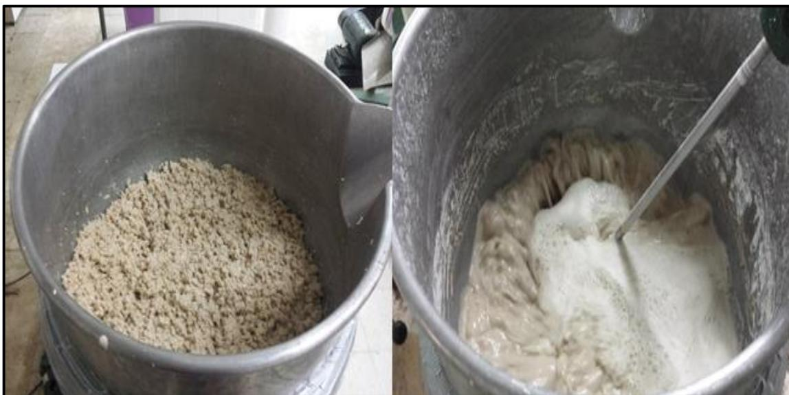
Figura 3.14 Degradación de la celulosa mediante la hidrólisis enzimática a nivel planta piloto
