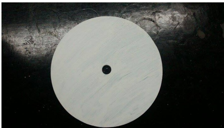
Figura 3.6 Impregnación de uno de los discos del RFDR con \text{TiO}_2
