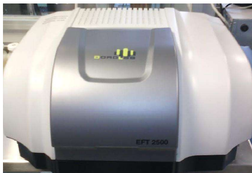
Figura 2.5 Espectrómetro infrarrojo modelo EFT 2500
