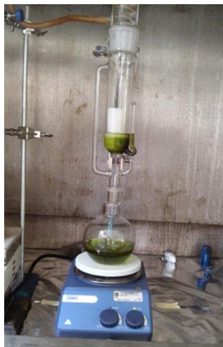
Figura 2.3 Extracción con etanol-benceno en equipo Soxhlet
