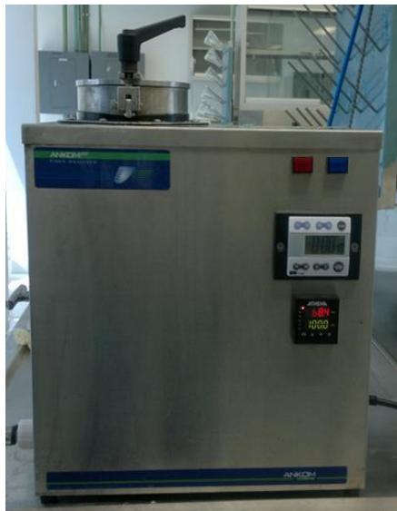
Figura 2.3 Equipo para determinación de lignocelulósicos
