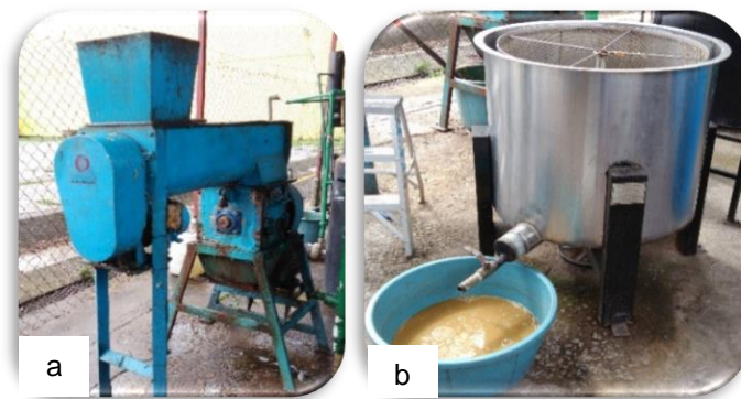
Figura 1.6 a) Trituradora VEYCO; b) Centrifuga semiindustrial de RSOM
