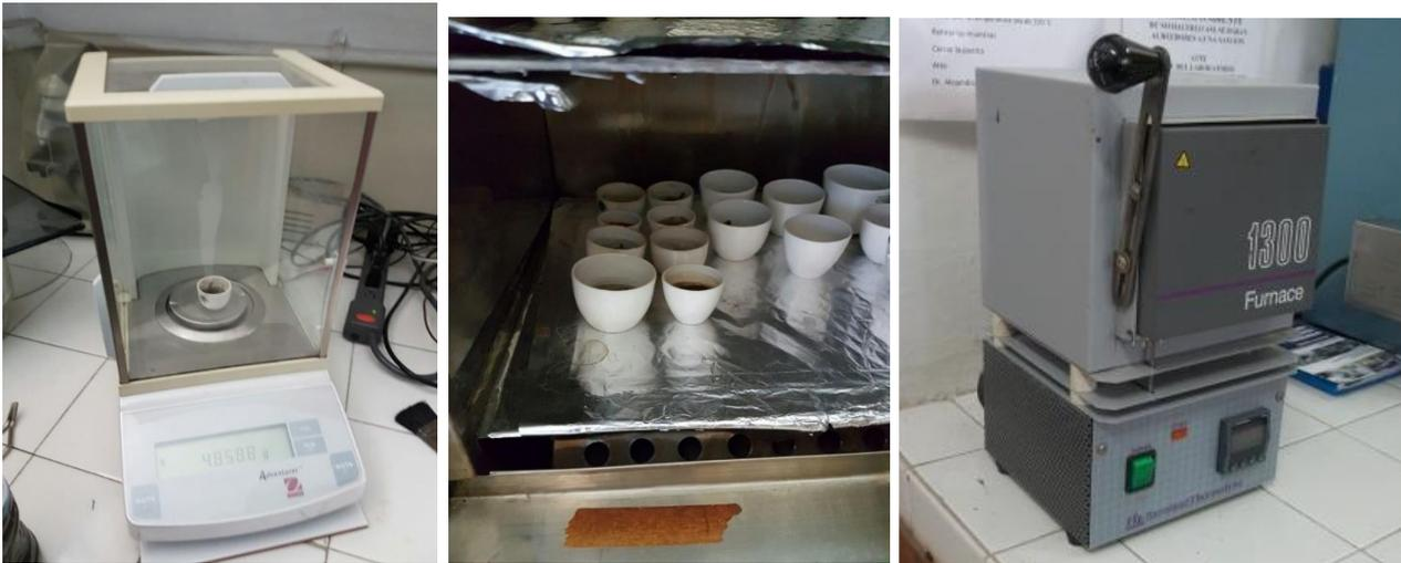
Figura 2. 7 Balanza analítica, estufa con muestras, mufla utilizados
