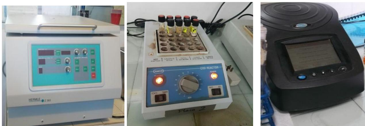
Figura 2. 6 Centrifuga, placa digestora y espectrofotómetro utilizados
