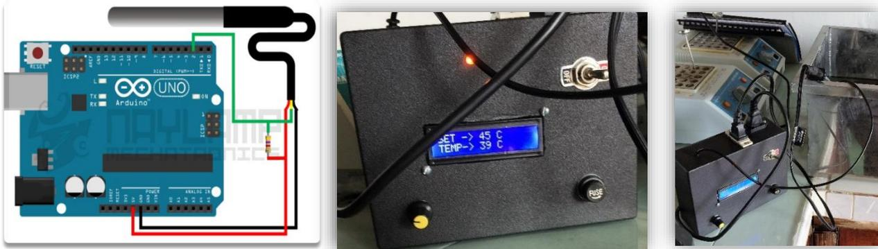
Figura 3.1 Sensor de temperatura, controlador de temperatura, baño termostático
