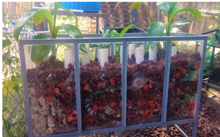
Figura 3.24 Celda con material de soporte.
