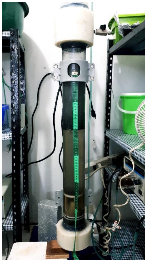
Figura 3.11 Reactor Anaerobio Híbrido con soporte colonizado
