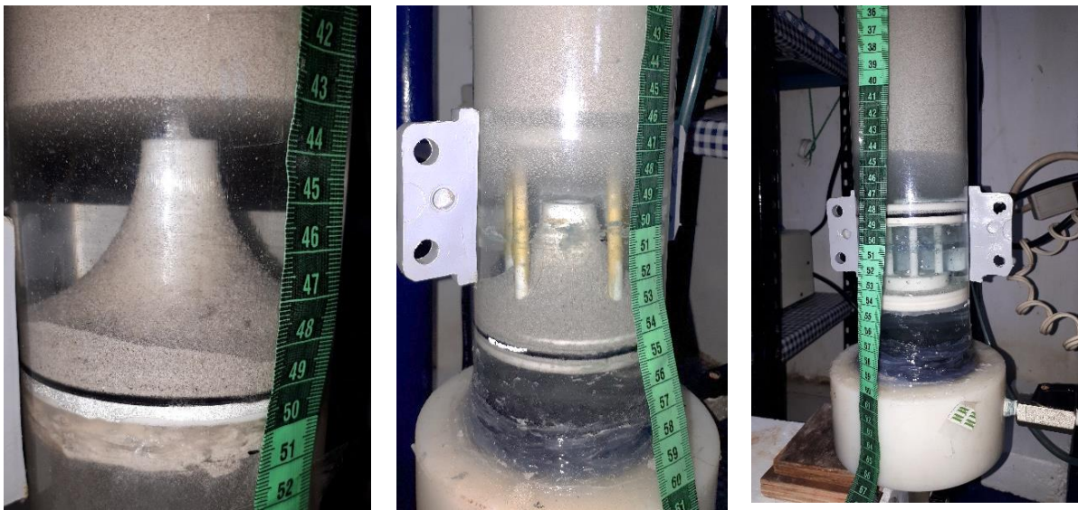
Figura 3.20 Retención de soporte limpio con los diseños a) cono invertido, b) cono invertido con placa, c) placa perforada con orificios.
