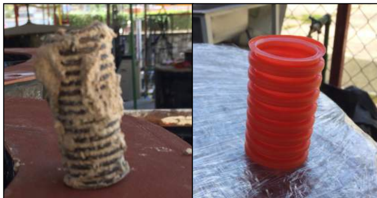
Figura 3.12 Tipos de lecho fijo utilizados colonizado (izquierda), no colonizado (derecha)
