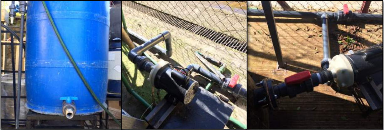
Figura 3.9 Sistema de alimentación y recirculación de sustrato
