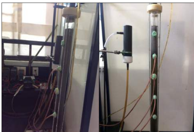
Figura 3.2 Operación del RLF con los sensores con puntas de plata
