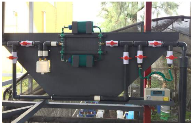
Figura 3.22 Proceso de limpieza y medidor de flujo de biogás
