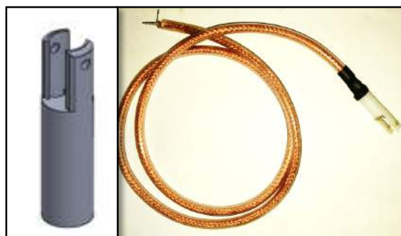
Figura 2.15 Sensor con puntas de plata utilizado en la segunda prueba
