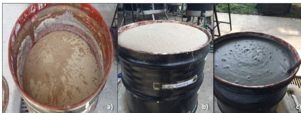
Figura 3.4 Preparación del inóculo. a) Soporte limpio, b) biogás generado, c) soporte colonizado
