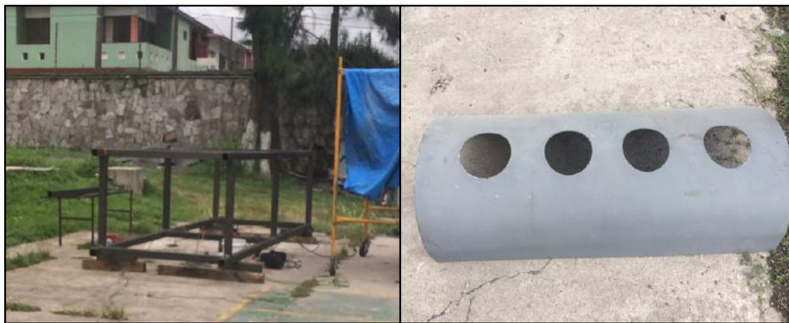
Figura 3.5 Estructura de sujeción para el tanque de distribución
