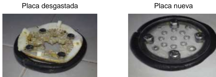
Figura 3.1 Cambio de la placa interna semi-fluidizada del RLSFI
