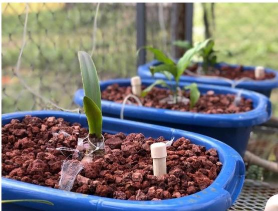
Figura 3.2 Celda con tubería para sondas
