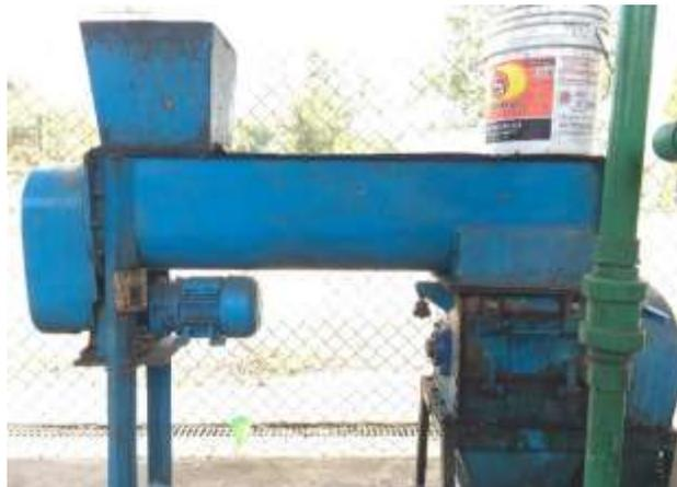
Figura 2. 4 Molino triturador de cuchillas con tornillo transportador
