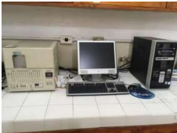
Figura 2. 9 Cromatógrafo Buck 310
