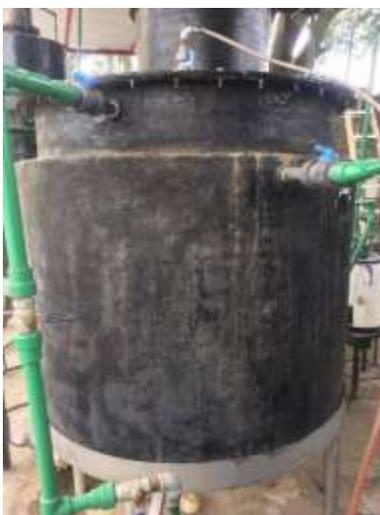
Figura 2. 6 Reactor Hidrolítico
