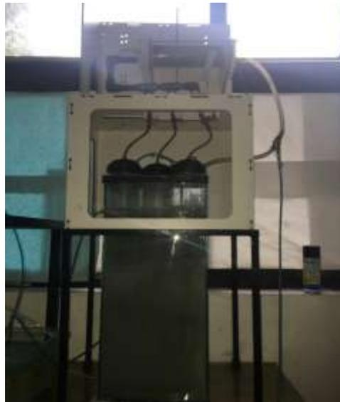
Figura 1. 13 Reactor de Lecho Fluidizado Inverso con Arreglo en Paralelo (RLFIAP) (Juárez-García, 2016)
