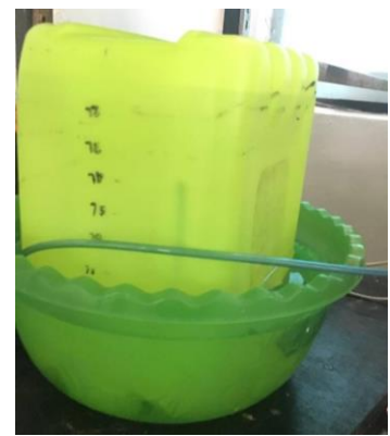
Figura 2.7 Colector de biogás
