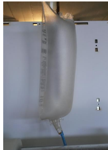
Figura 3.17 Captación de biogás
