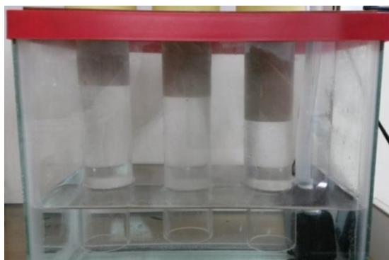
Figura 2.10 Extendsphere® dentro de los RLFI (20, 30 y 40% volumen de soporte de izquierda a derecha)
