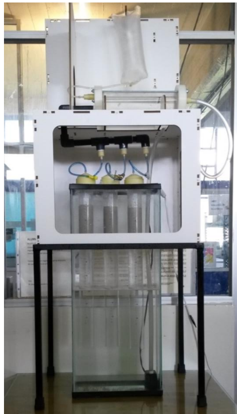
Figura 3.2 Reactor Anaerobio Multitubular (RAM) segunda etapa
