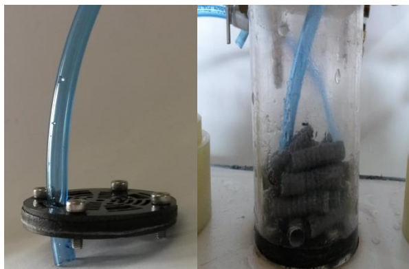
Figura 2.19 Manguera en placa difusora (fuera y dentro del tubo)
