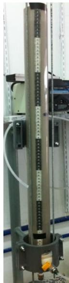
Figura 2.4 Extendsphere totalmente expandido dentro del RLSFI
