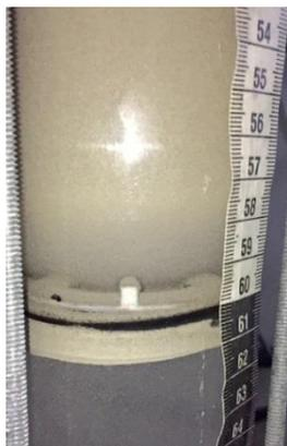
Figura 3.12 Soporte limpio retenido por la placa de orificio de 1 mm
