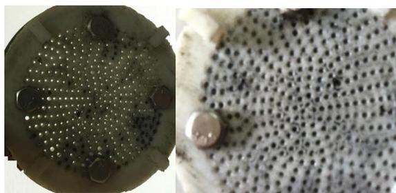
Figura 3.13 Placa de orificio de 1 mm después de operar al RLSFI con soporte colonizado
