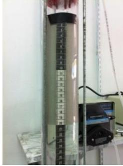
Figura 2.3 Extendsphere limpio dentro del RLSFI antes de iniciar la expansión
