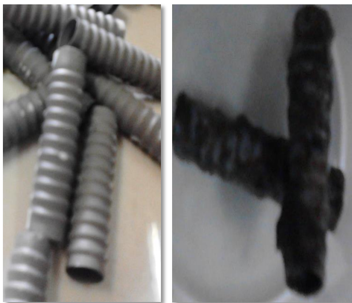
Figura 3.6 Soporte de polietileno del FA sin colonizar lado izquierdo y colonizado lado derecho
