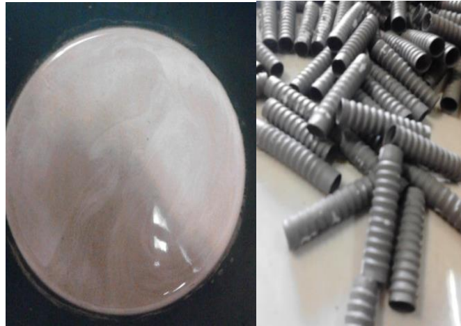
Figura 2.3 Lado izquierdo soporte colonizado y lado derecho tubos sin colonizar de polietileno
