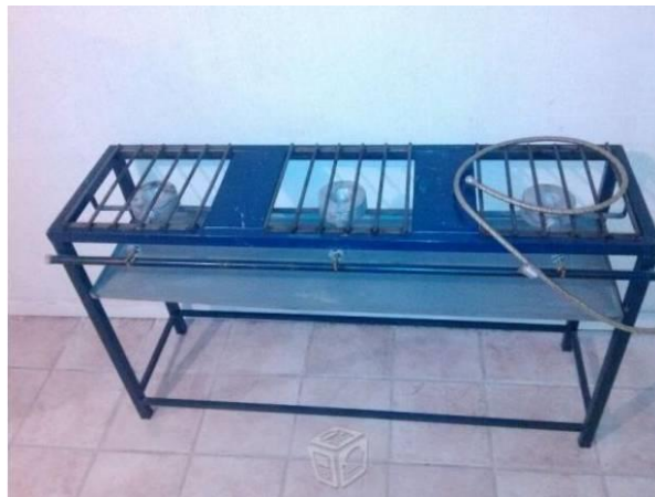
Figura 3.8 Conexión de biogás y parrilla.
