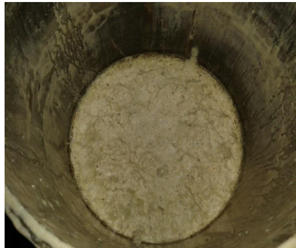
Figura 3.13 Presencia de nata en el lecho fluidizado.
