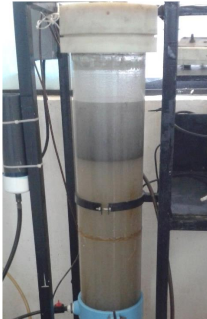
Figura 2.12 Lecho fluidizado (altura = 16 cm).
