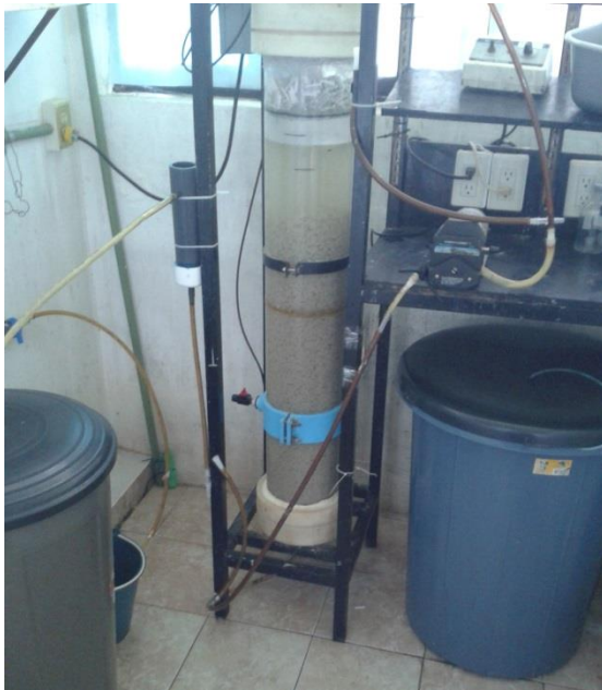
Figura 3.17 Reactor híbrido durante el proceso de coagulación-floculación del Extendosphere™ colonizado.
