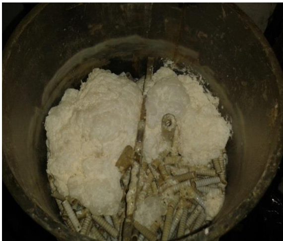
Figura 3.12 Presencia de nata en el lecho fijo.
