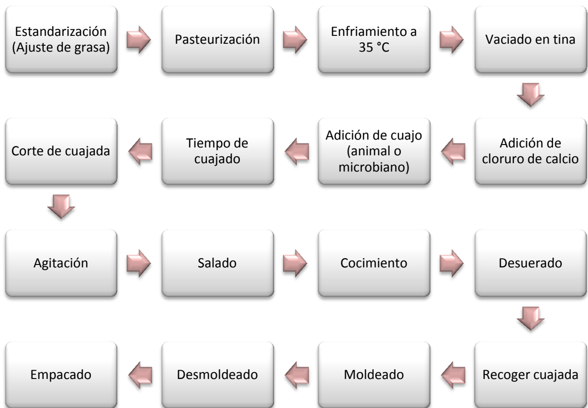
Figura 1.2 Proceso para la fabricación del queso fresco (Galván, 2005).
