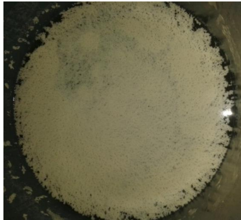
Figura 2.2 Aglomeración de proteínas por ajuste de pH en el lactosuero.
