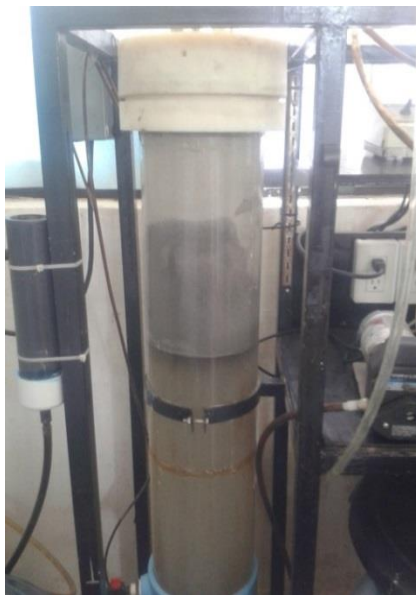
Figura 2.13 Lecho fluidizado adicionado con soporte precolonizado (altura = 22 cm).
