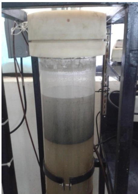
Figura 2.6 Soporte Extendsphere™ en el interior del reactor híbrido.
