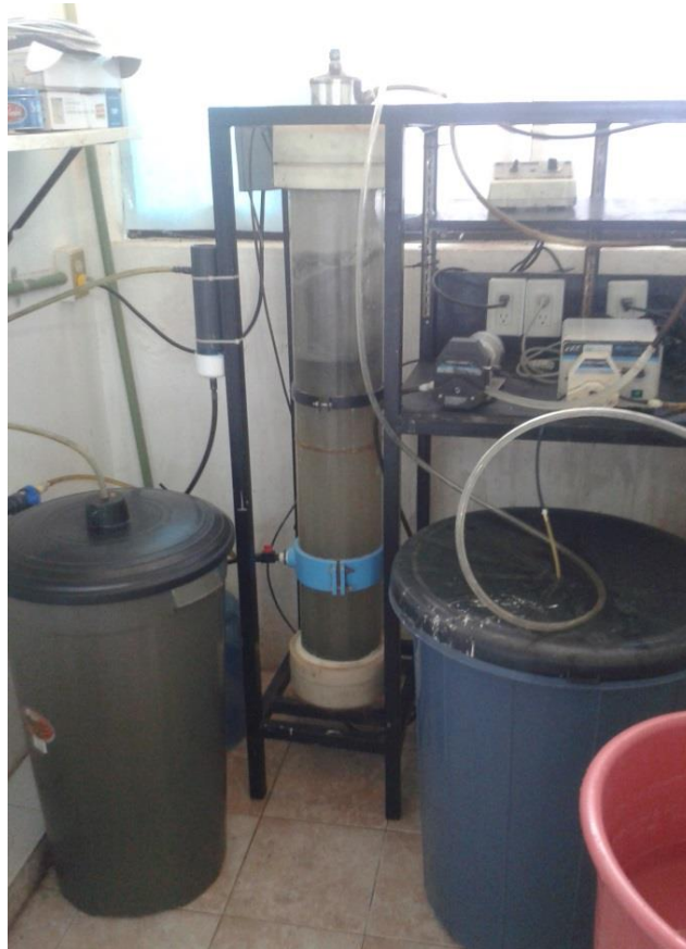
Figura 2.11 Mantenimiento del reactor híbrido previo al arranque.
