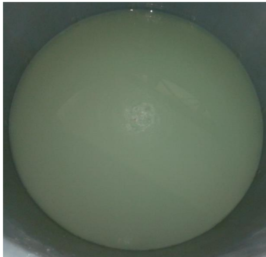
Figura 3.1 Lactosuero acondicionado y con adición de \text{NaHCO}_3 para ajuste de pH.
