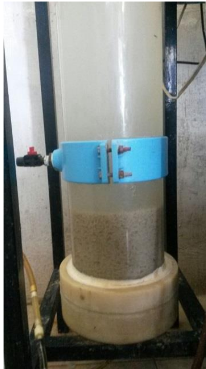
Figura 3.19 Extendsphere™ colonizado completamente sedimentado.
