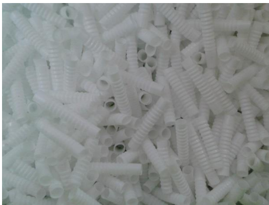
Figura 2.8 Polietileno cilíndrico corrugado sin recubrimiento de nitrocelulosa.
