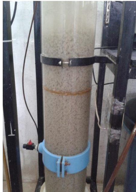
Figura 3.18 Proceso de sedimentación de los flóculos formados por Extendosphere™ colonizado.
