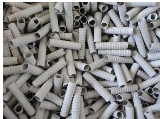
Figura 2.9 Polietileno cilíndrico corrugado con recubrimiento de nitrocelulosa.
