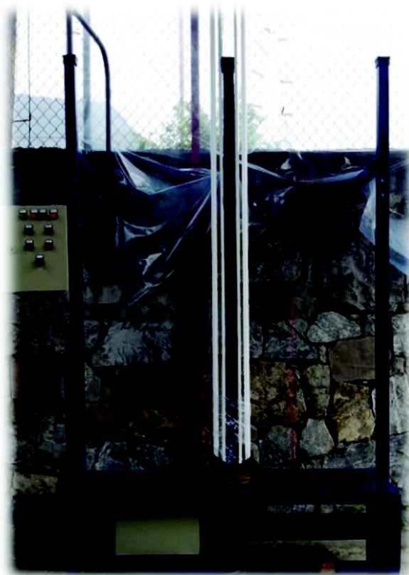
Figura 3. 23 Base para fotobiorreactor, lámparas y control de bombas
