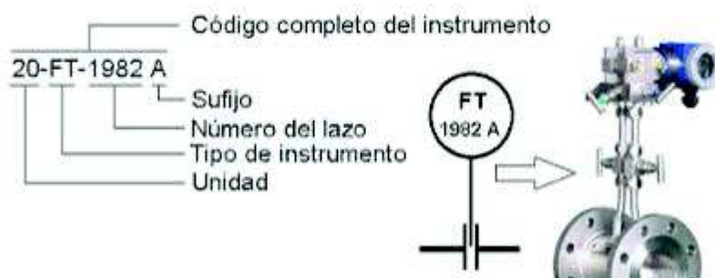
Figura AD. 1 Codificación de un instrumento en un P&ID
