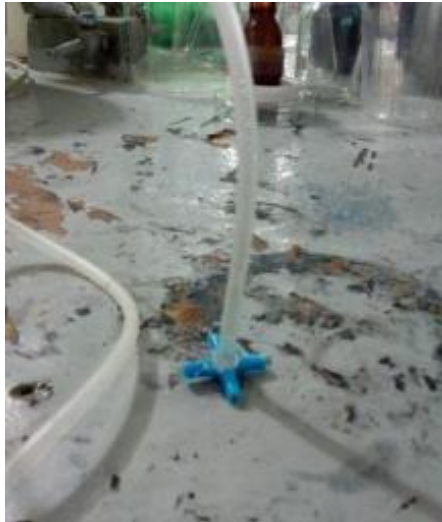
Figura 2.6 Montaje del sistema de agitación por burbujeo
