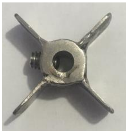
Figura 2.3 Diseño de agitador de paletas planas
