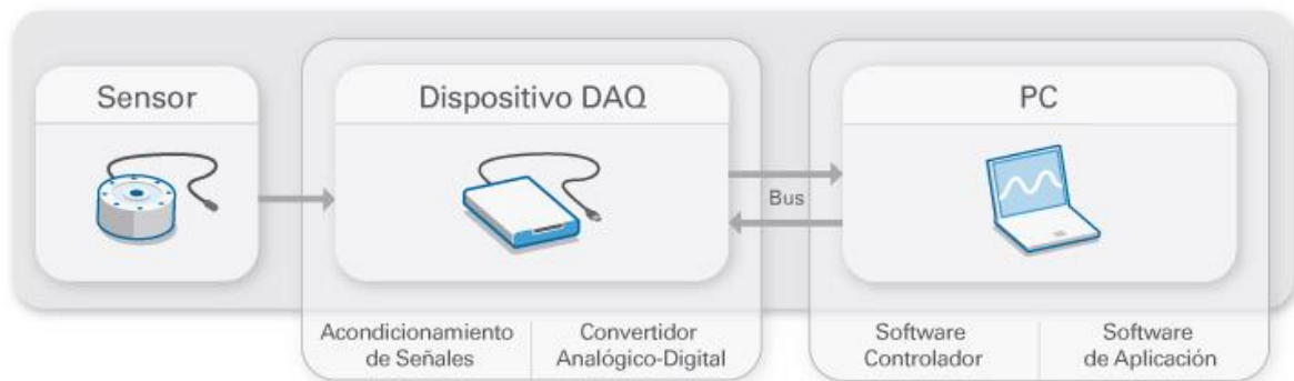
Figura 1.6 Sistema de adquisición de datos basado en una computadora (Mendiburu, 2010)
