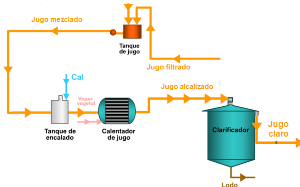
Figura 1.4 Clarificación o defecación simple en el proceso de elaboración de azúcar crudo (CENICAÑA, 2004)
