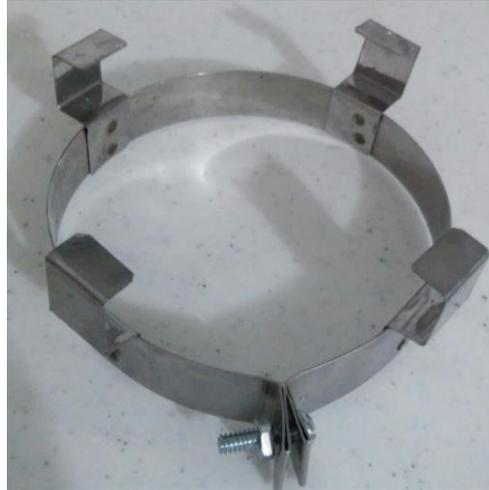
Figura A.3 Abrazadera de acero inoxidable tipo anillo
