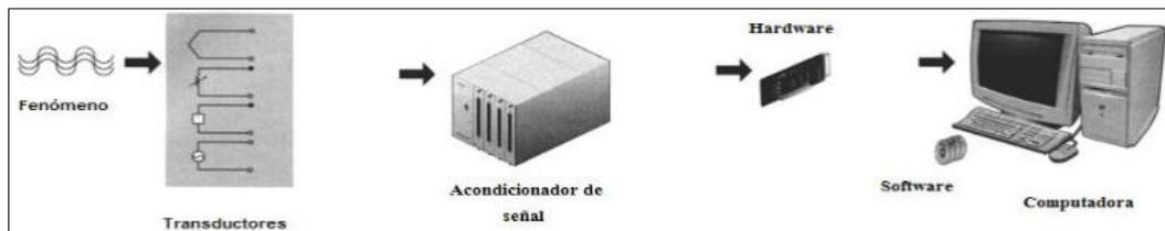
Figura 1.5 Sistema de adquisición de datos basado en una computadora
