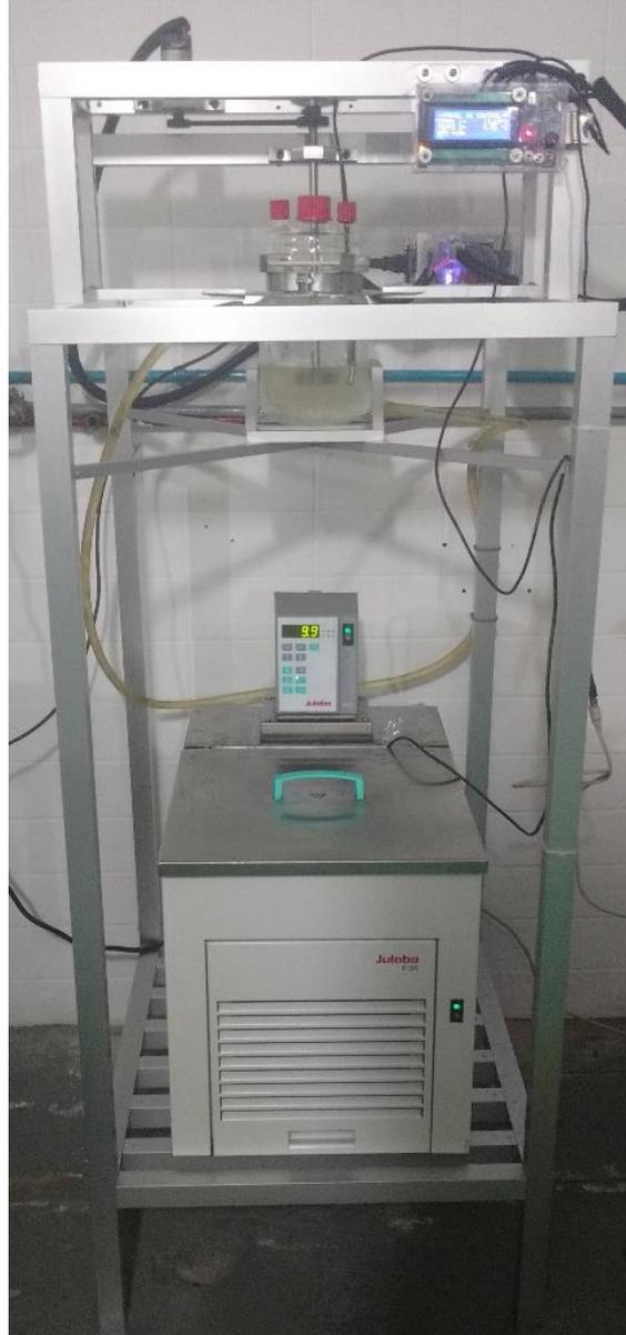
Figura 3.8 Montaje del sistema de cristalización por lotes
