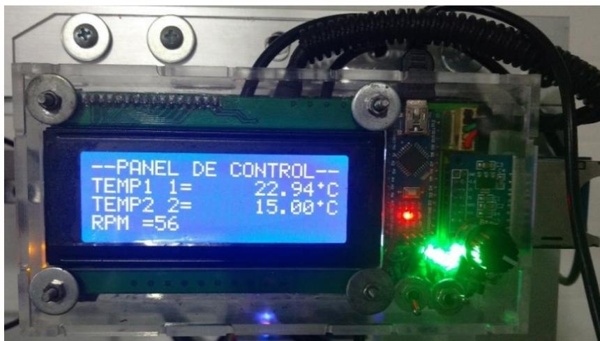
Figura A.5 Panel de control físico
