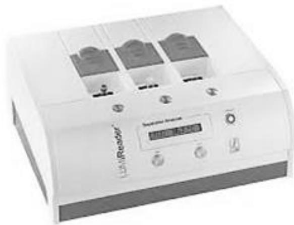
Figura 2.3 Analizador de separaciones LUMiReader® 4131-3
