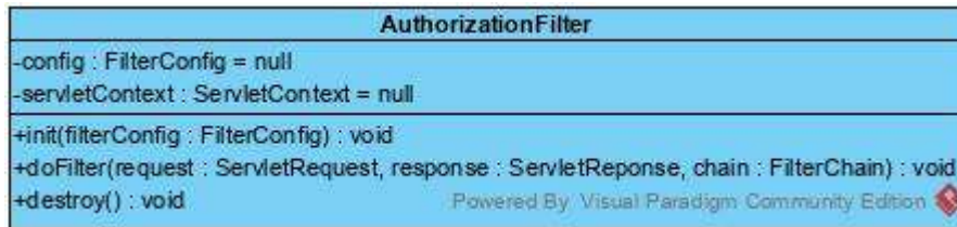
Figura 3.3.3 Diagrama de clases correspondiente al paquete filter
